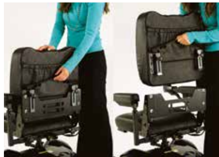
El Back-Off retira fácilmente la parte posterior del dispositivo de movilidad para que quepa en aberturas más reducidas de vehículos
